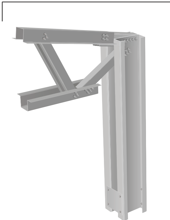
POŁĄCZENIE PRZEGUBOWE NA SŁUPIE STALOWYM
