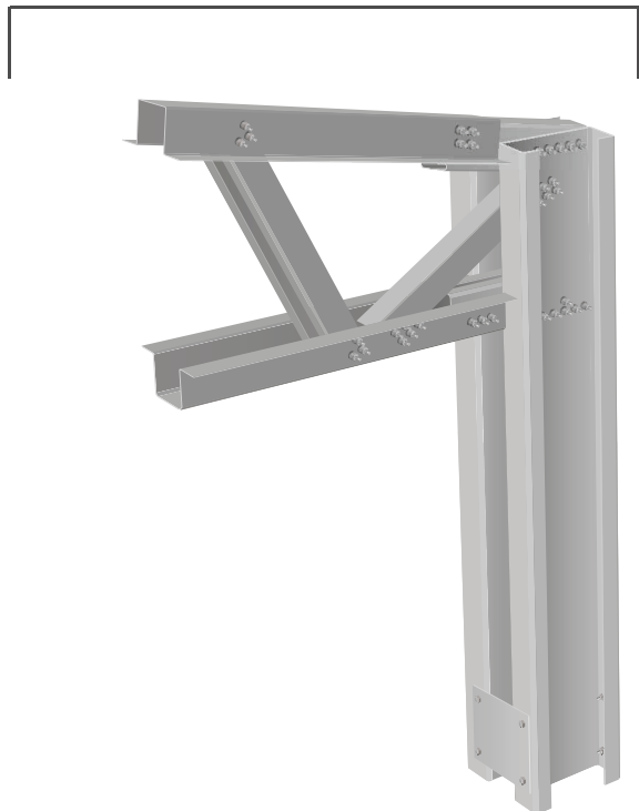
POŁĄCZENIE SZTYWNE NA SŁUPIE STALOWYM
